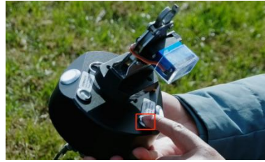
图 7-2-2 打开脱钩器挂钩
