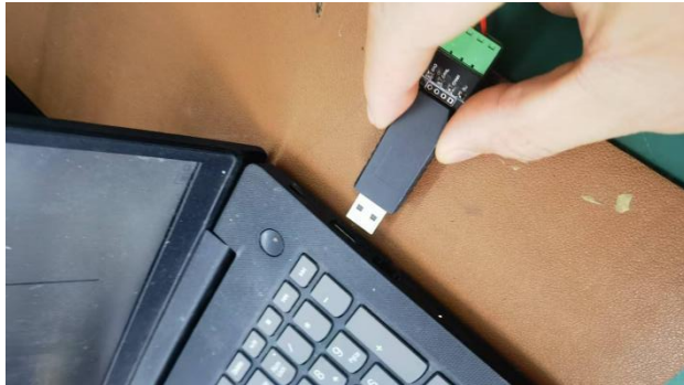
图 5-2-3 USB 转接通讯模块插入电脑 USB 端（B 端）
