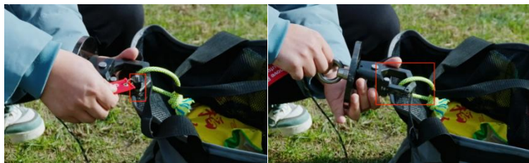
图 7-1-2 货物挂入脱钩器凹槽处
