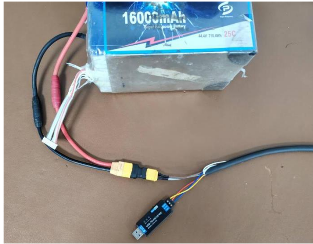
图 5-2-2 12S 动力电池供电连接（B 端）
