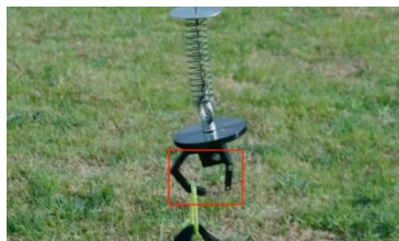
图 8-1-5 货物卸载（机械脱钩器无安全销）
