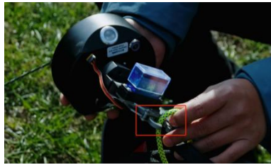
图 7-2-3 货物挂入电控脱钩器
