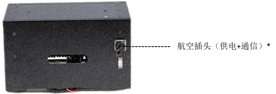
图 3-2-3 EayLoad-150 线路接口示意图
