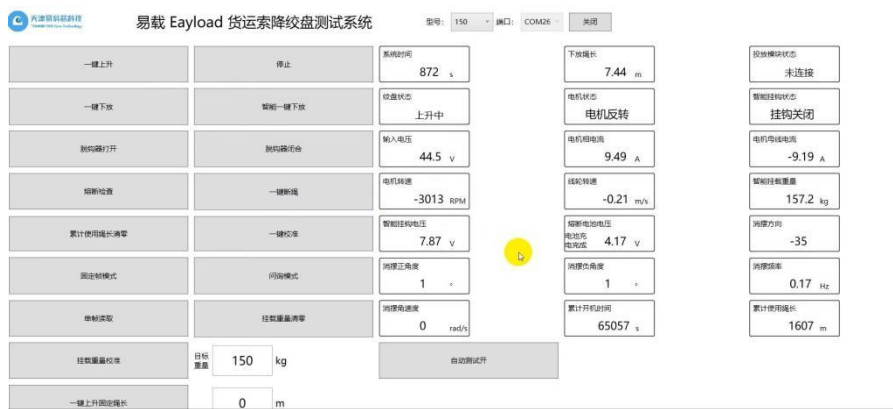
图 5-2-4 打开上位机软件进行数据读取和控制操作
