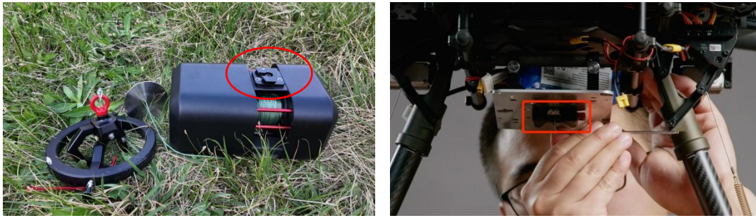
图 5-1-1 快拆安装件在飞行平台上安装
