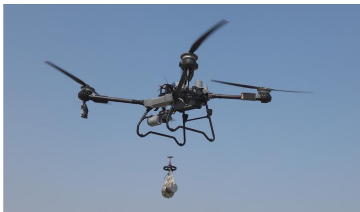
图 3-1-1 搭载 EayLoad-25 无人机空载绞盘系统无人机平台
