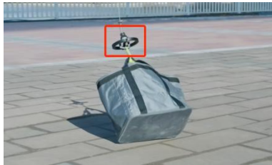
图 7-1-8 确认脱钩器挂起货物
