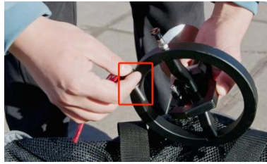
图 7-1-5 缆绳下放一定长度，拔下安全销
