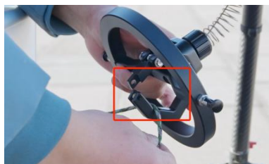
图 7-1-3 货物挂入脱钩器凹槽处
