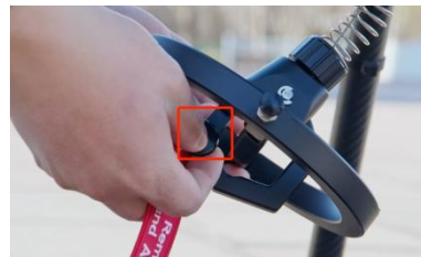
图 7-1-2 拔出脱钩器安全销
