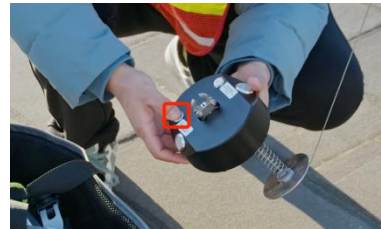
图 7-2-2 打开脱钩器挂钩
