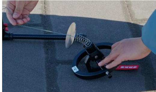
图 5-4-2 确保缆绳无缠绕及脱钩器复位
