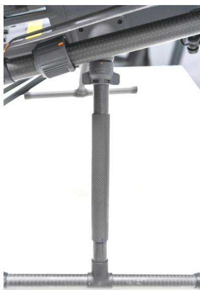
图 5-2-1 加长起落架安装
