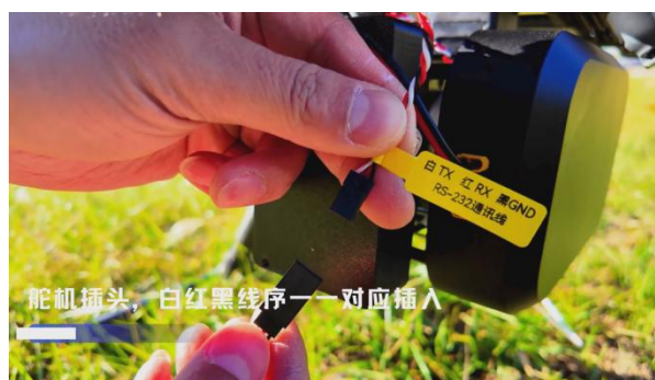
5-3-3 PSDK 转接模块，通讯线安装
