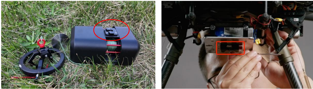
图 5-1-1 快拆安装件在飞行平台上安装
