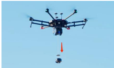
图 7-2-1 缆绳下放到地面
