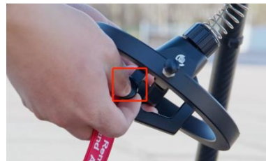
图 7-1-2 拔出脱钩器安全销
