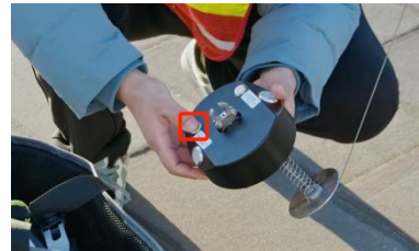
图 7-2-2 打开脱钩器挂钩
