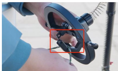
图 7-1-3 货物挂入脱钩器凹槽处
