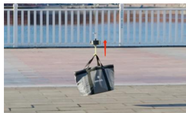
图 7-2-5 飞行平台上升将货物拉起
