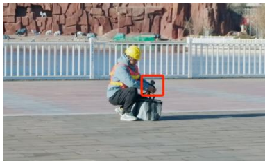
图 8-1-3 拔下安全销取走货物
