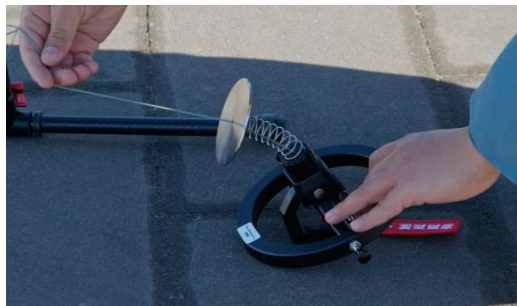
图 5-3-2 确保缆绳无缠绕及脱钩器复位
