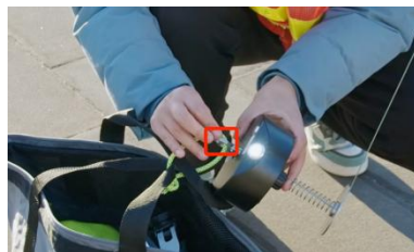
图 7-2-3 货物挂入电控脱钩器
