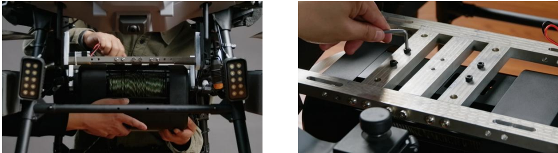
图 5-1-1 绞盘主体在飞行平台上安装
