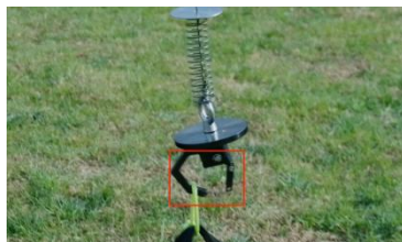
图 8-1-5 货物卸载（机械脱钩器无安全销）
