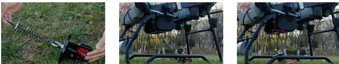
图 5-2-4 确保缆绳无缠绕及脱钩器复位
