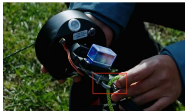
图 7-2-3 货物挂入电控脱钩器
