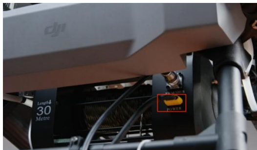
图 5-2-2 供电线插入绞盘供电口
