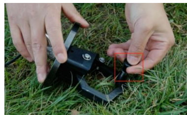
图 7-1-2 拔出脱钩器安全销
