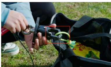
图 7-1-3 货物挂入脱钩器凹槽处
