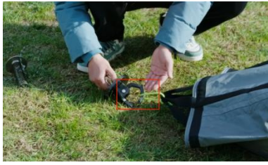
图 7-1-5 货物挂入脱钩器凹槽处
