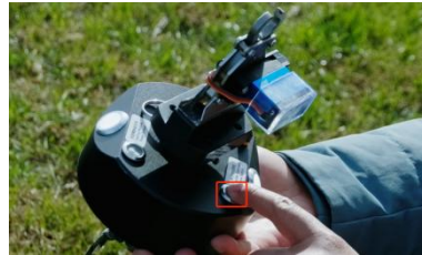
图 7-2-2 打开脱钩器挂钩
