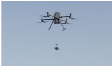
图 7-2-1 缆绳下放到地面
