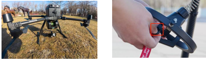
图 7-1-1 拔出脱钩器安全销
