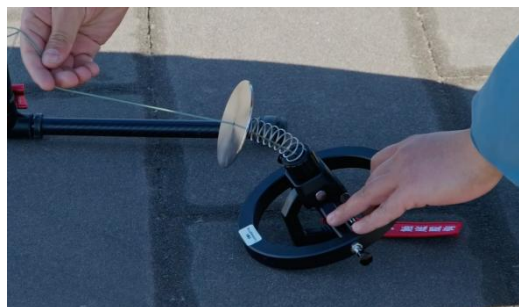
图 5-4-2 确保缆绳无缠绕及脱钩器复位
