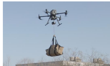
图 8-1-2 货物下放至地面触底停止
