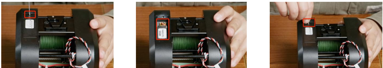
图 5-2-1 熔断电池安装
