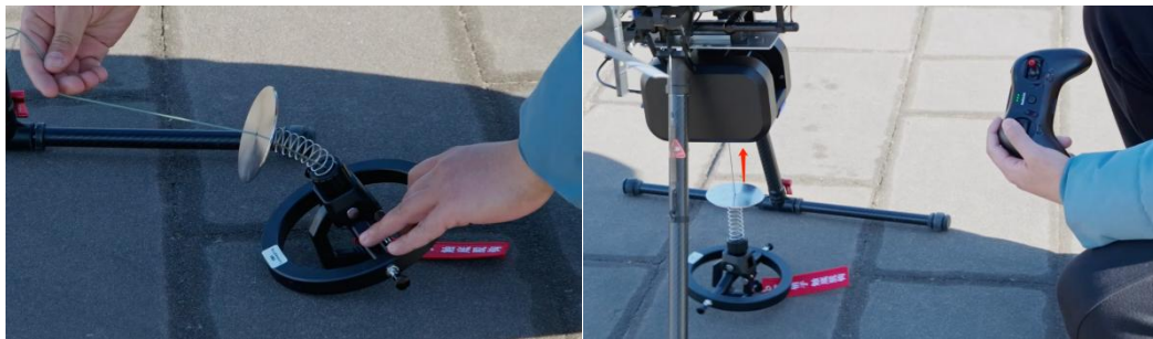
图 5-3-3 确保缆绳无缠绕及脱钩器复位
