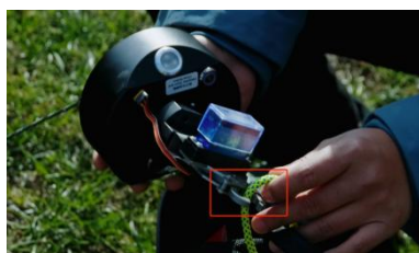
图 7-2-3 货物挂入电控脱钩器
