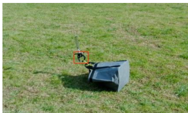
图 7-1-4 确认脱钩器挂起货物
