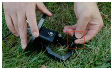
图 7-1-1 拔出脱钩器安全销
