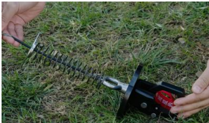
图 5-2-5 确保缆绳无缠绕及脱钩器复位
