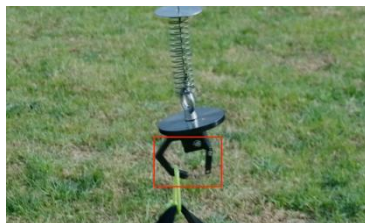
图 8-1-5 货物卸载（机械脱钩器无安全销）
